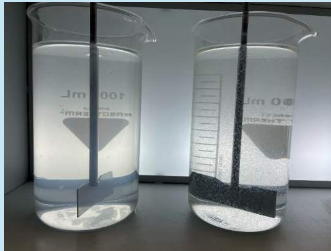
Figura 3: Efeito comparativo do polissulfato de alumínio adicionado sem agitação (foto da esquerda) e com agitação (foto da direita).
